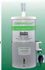
I LED di vari colori (verde, giallo e rosso) sul dispositivo indicano la qualità del gas di scarico filtrato e di conseguenza il livello di riempimento del canestro.
