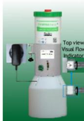
A6. Raccorder le port de sortie de l'indicateur visuel de débit de l'unité de contrôle de niveau SENSOfluran CONNECT à la connexion de mur ou de plafond WAGD comme représenté en section 5. Vérifier que le raccordement est serré et sécurisée et que le collier est monté. Contrôler l'aptitude fonctionnelle de la connexion à l'évacuation des gaz anesthésiques (WAGD) avec l'indicateur visuel de débit. Le clapet noir de l'indicateur visuel de débit ne doit pas être vertical.
